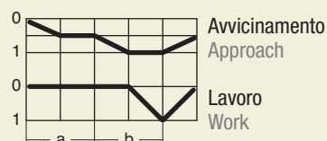
a: posizionamento positioning b: salvamano azionato operated two-hand control
